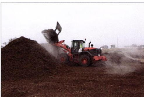
Bild 1: Aufsetzen einer Miete mit Radlader
