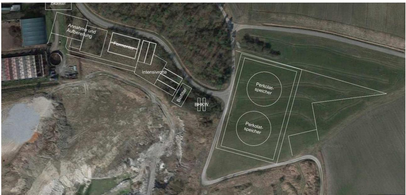
Abb. 41: Anlagenlayout für eine Anlage mit Pfropfenstromverfahren (ohne Nachrotte)
