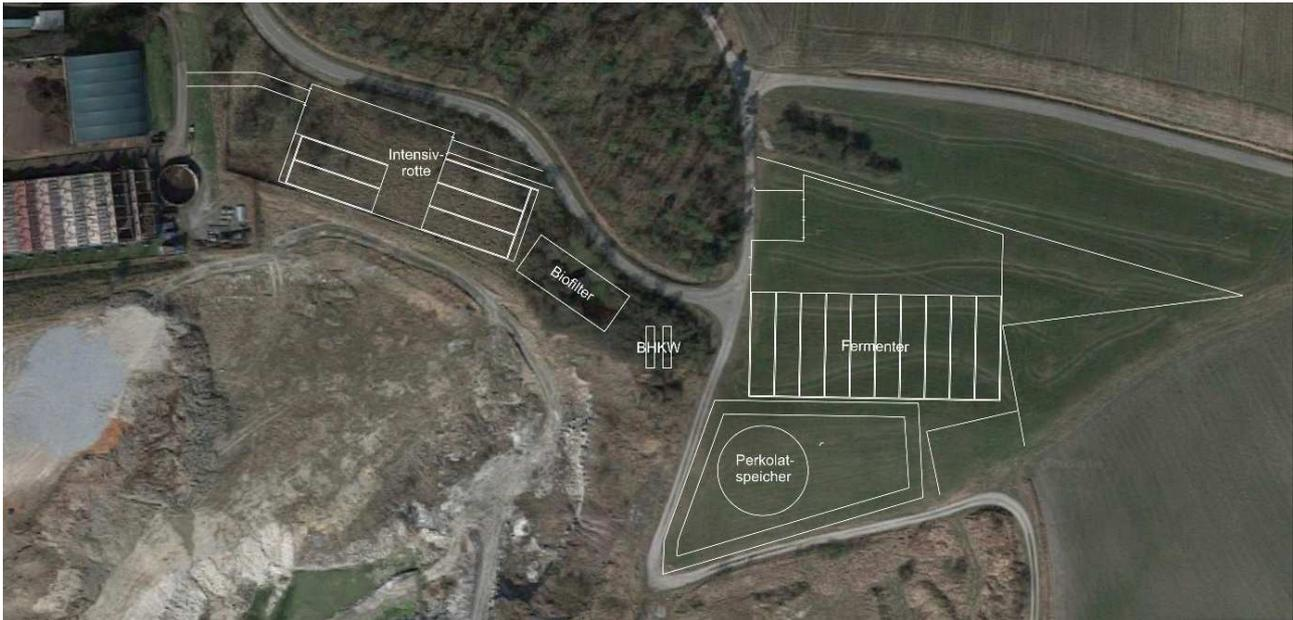
Abb. 40: Anlagenlayout für eine Anlage mit Boxenverfahren (ohne Nachrotte)
