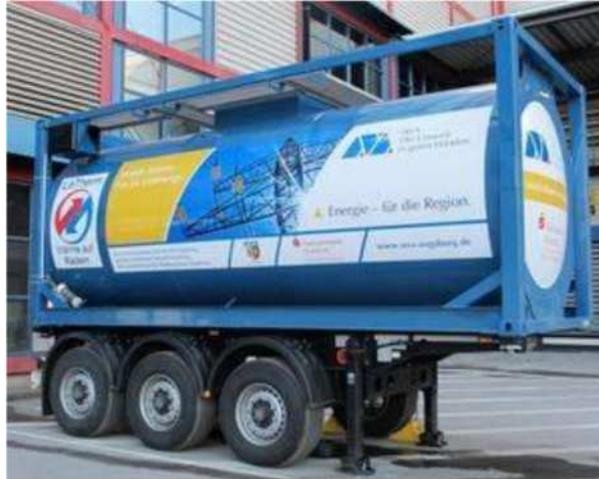
Abb. 25: Beispiel: Mobiler Latentwärmespeicher (AVA Augsburg); Quelle: AVA GmbH
