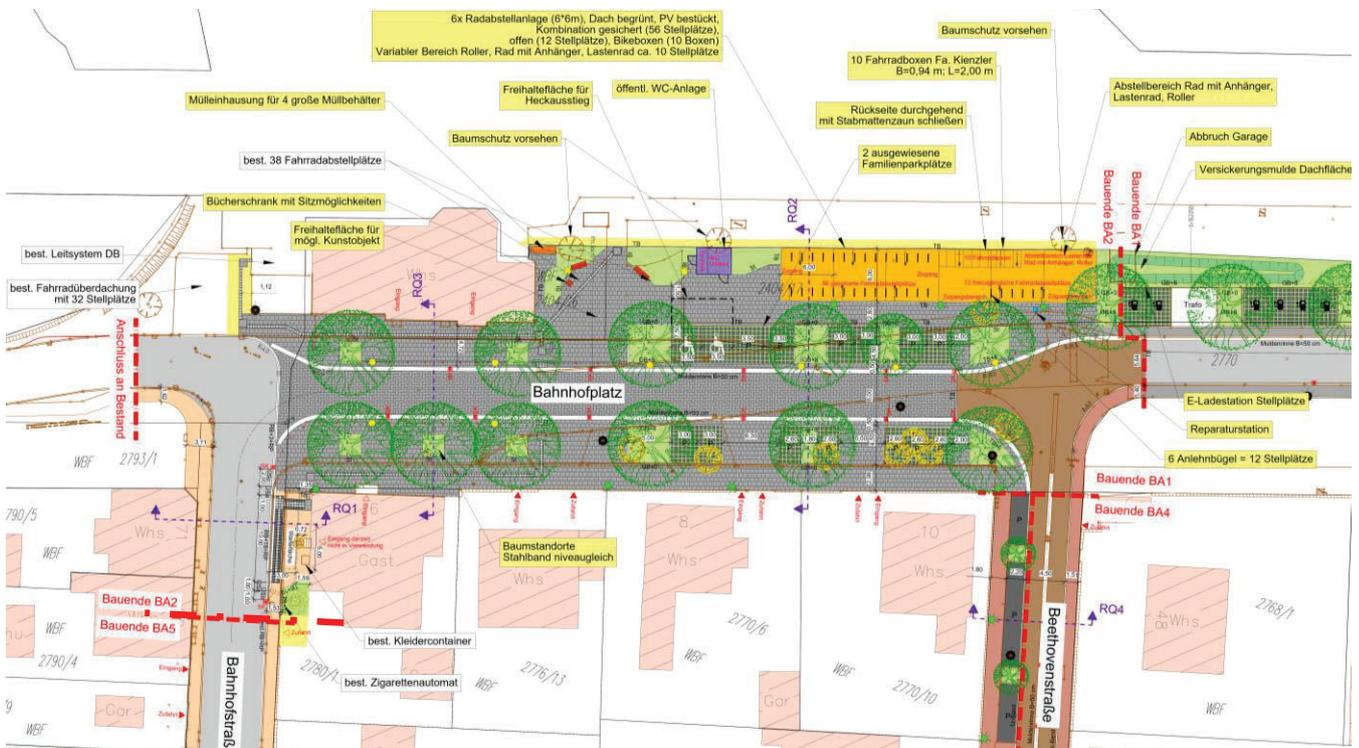
**Abbildung 2-2:** Gestaltungsvorschlag 2. Bauabschnitt Bereich am Bahnhof
